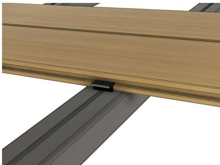
Para fijar el resto de tablas al rastrel usar la guía del rastrel de WPC o simplemente atornillar el clip en el centro del rastrel utilizado.
